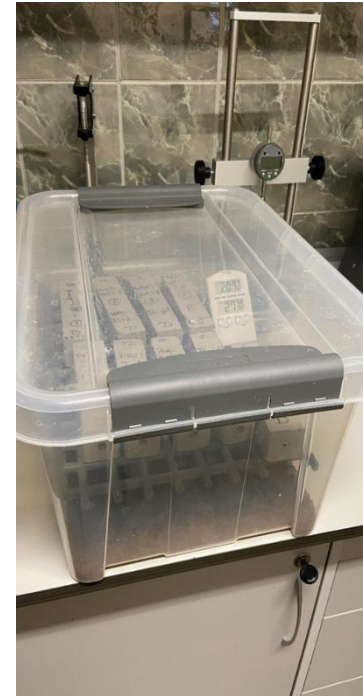
Rys. nr 5. Pielęgnacja próbek w eksykatorze.
