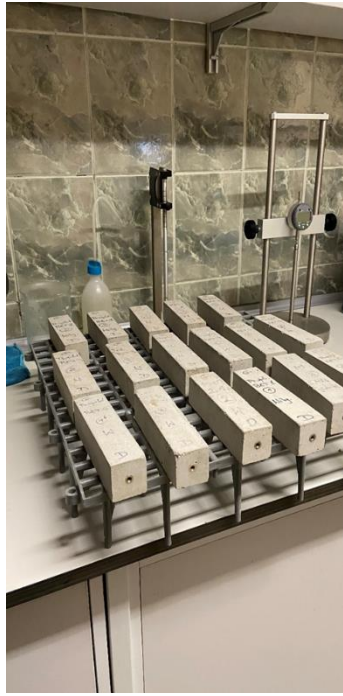
Rys. nr 4. Pielęgnacja próbek w komorze wilgotnej.
